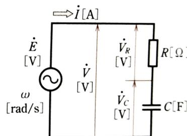
図22 RC直列回路の回路図
