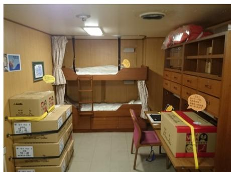
観測隊員の船室展示です。パソコンや荷物、ベッドにまで、激しい揺れに備えて固定ベルトがついています。なお、しらせの揺れの最大傾斜角度は左に  $53^\circ$ 、右に  $41^\circ$  だそうです。
