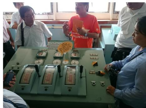
氷を割って進むチャージングという航法を効率よく行うため、3 系統の原動力を操作します。
