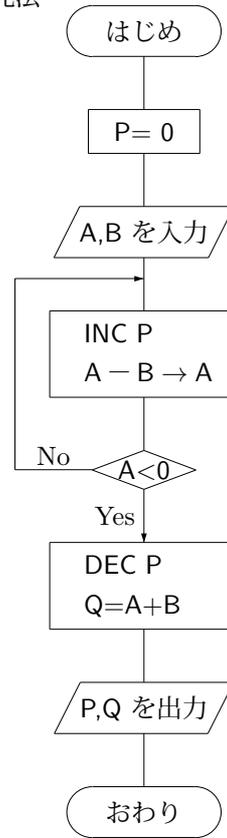
非復元法が普通の考えのようだが、実は違うのかもしれない。ここがこの「実におもしろい」ところである。機械で実行すると復元法の方が断然速い。何故かという、非復元法の比較  $A < B$  は、実際には引き算を実行しキャリーフラグ<sup>2</sup>をチェックしている。これを毎回実行しているのに対し、復元法の場合は引き算をしたときに自動的に生じるキャリーフラグのチェックを使っている。即ち、非復元法は1回のループの間に引き算を2回実行していることになる。1ステップ戻る復元法が、一見非合理的
